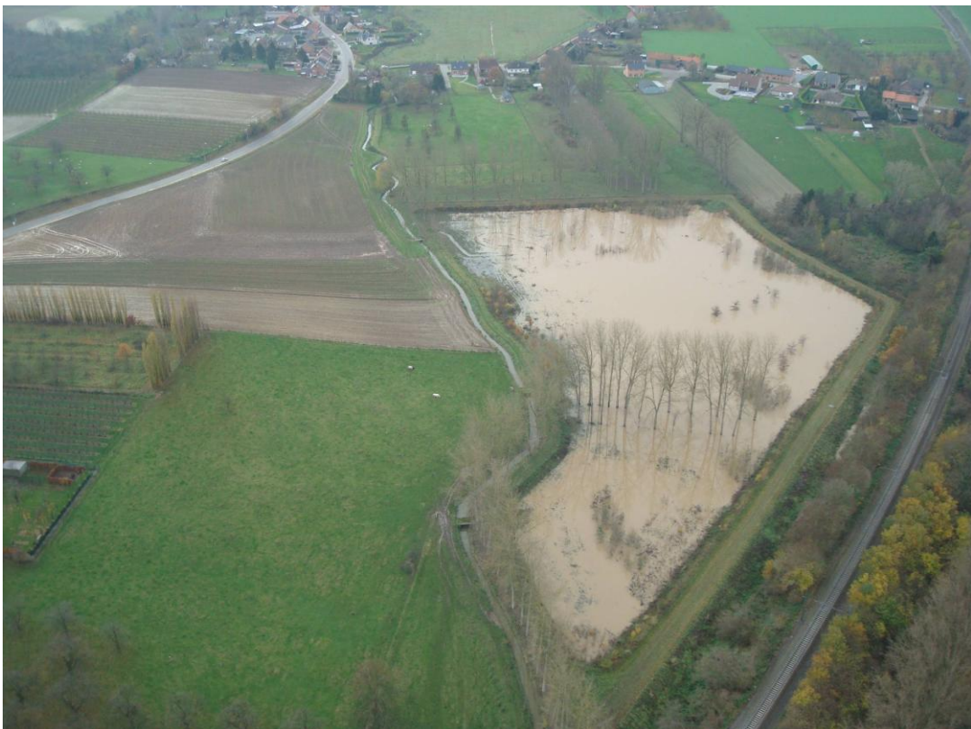
Foto : gecontroleerde overstromingszone te Stayen in werking (november 2010)
